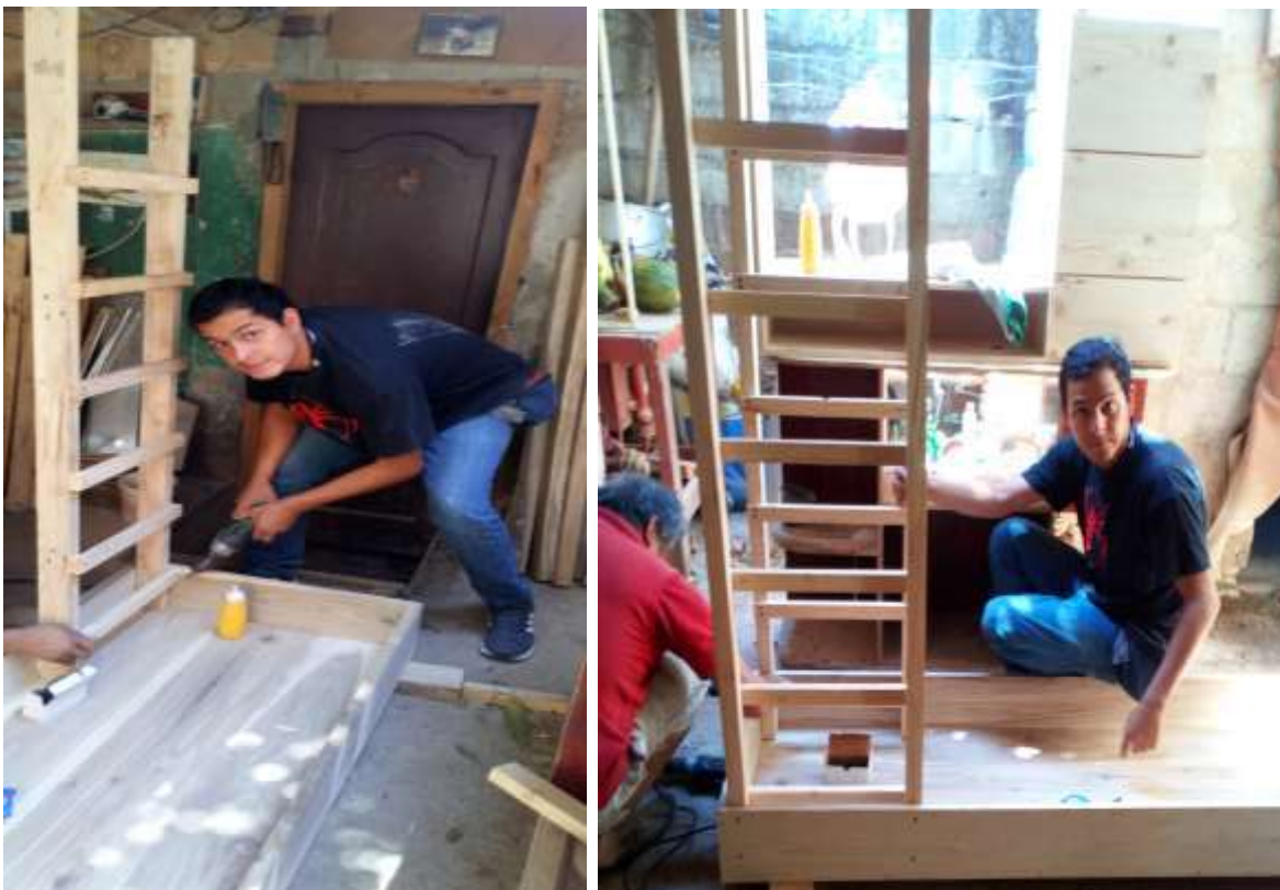
Figura 76. Unión de piso y porta bandejas López, 2021
