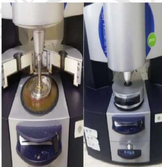
Fotografía 1. Preparación de muestra y ensayo de viscoelasticidad.
